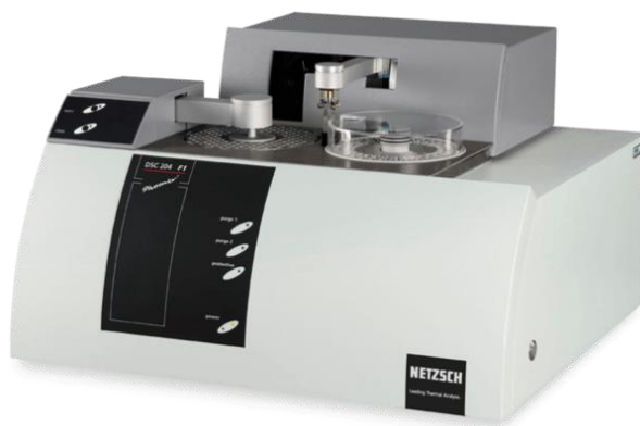
Рисунок 3.4 – Дифференциальный сканирующий калориметр DSC 204 F1 Phoenix.
